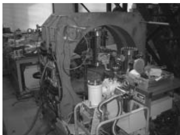
図2 ヘルムホルツコイルを利用したガス分散の実験装置（大型の容器内で粒子をガス中に安定して浮遊させ，磁場整列を観察）
