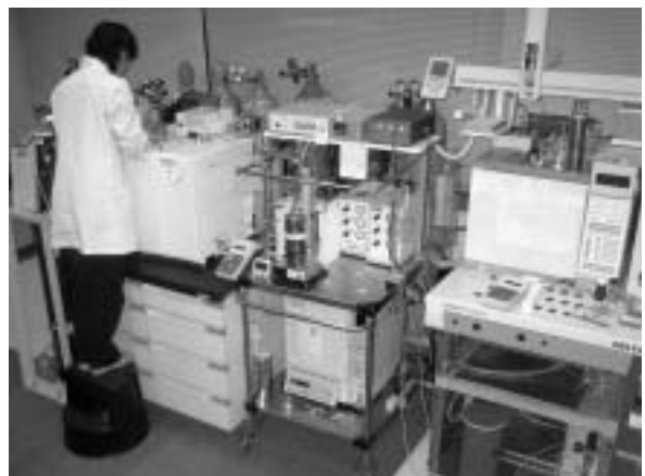
写真2 小川さんご自慢のEA/IRMSシステム。EAのオートサンプラーに試料をセットしてこれから測定を開始するところ。写真中央のワゴンにある配管&奇妙な物体は、現在開発中の nano-EAシステム。
