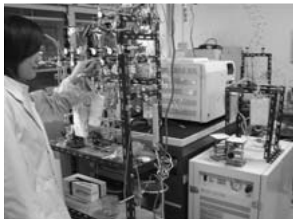
図4 海水中の溶存ガス抽出精製ライン(手前)と安定同位体比質量分析計(FinniganTMDELTA-plusXP)
