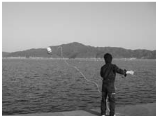
図2 大気-海洋インターフェースの観測：岩手県大槌湾にて表層水の24時間バケツ採水
