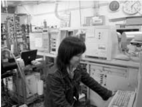
写真2：オンライン GC-C-IRMS を用いてメタンの炭素同位体比を測定中の M2 林さん
