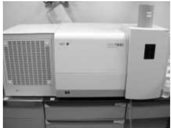
写真 4：誘導結合プラズマ原子発光分光分析計 研究室の機器では新顔。これからの活躍に期待です。
