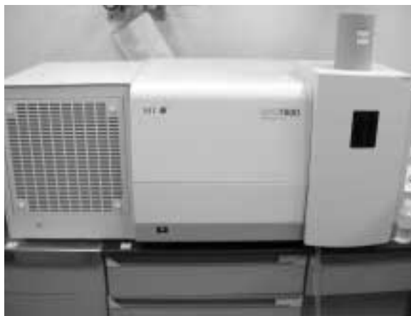
写真 4：誘導結合プラズマ原子発光分光分析計 研究室の機器では新顔。これからの活躍に期待です。
